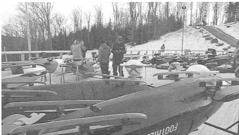
図 3 整備作業中のボブスレーの機体（裏返しの状態）
