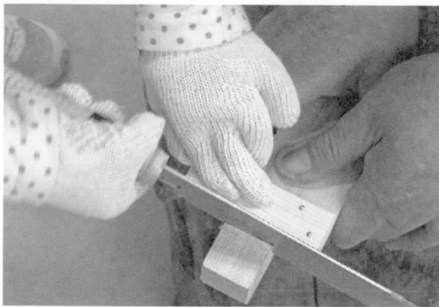
図8 ガイド治具で押さえて切る
