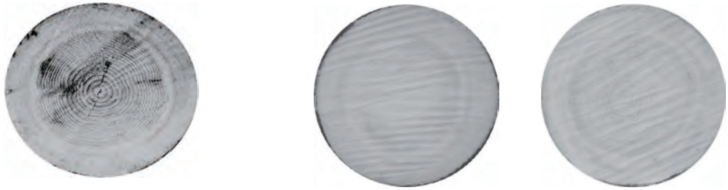
図 3. 赤外線年輪画像：(a) 特定したい年輪、(b) それ以外の年輪の例
