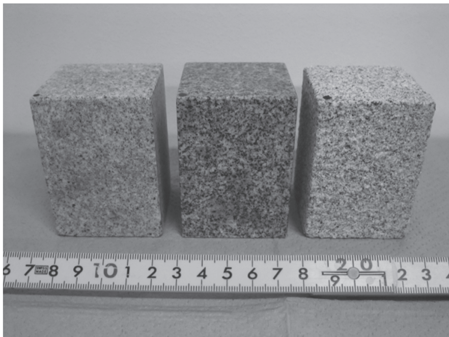
図1 実験に用いた試料の写真：(a) サンダー，(b) 磨き (c) ビシャン
